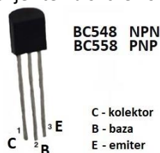
Slika 3. Raspored izvoda tranzistora
